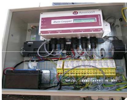
2. tous les câbles pour les capteurs (adaptions de la longueur, montage des fiches de connexion)
