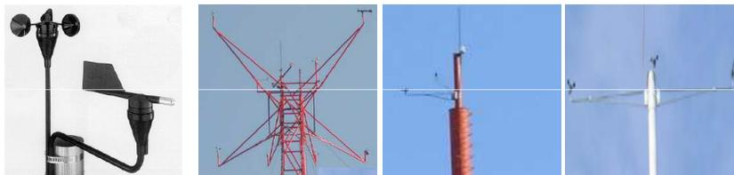
2. éviter toute perturbation de l'écoulement de l'air autour des capteurs (par des câbles des haubans, autres capteurs, etc.)
