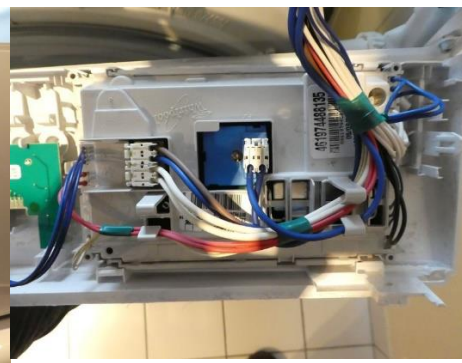
Retourner le bandeau après avoir décoché les ergots plastique sur la gauche. Défaire les connecteurs.
