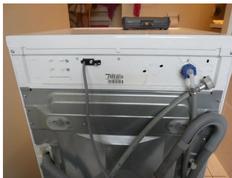
Défaire les 2 vis à l'arrière (à gauche et à droite) et enlever le couvercle de la machine
