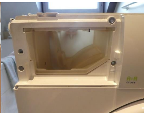
Extraire le tiroir à produit pour enlever 3 des 5 vis du bandeau. Les 2 autres vis sont accessibles à droite
