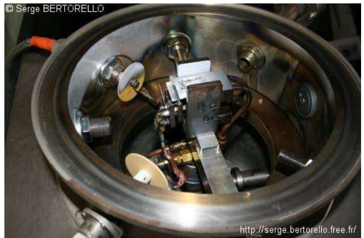
Figure 15 : Notre canon à électrons installé dans la base de l'enceinte.
