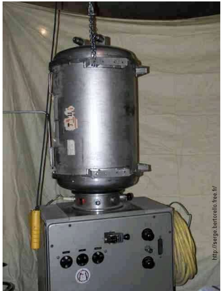
Figure 22 : Cuve employée pour la métallisation du miroir de 400mm.
