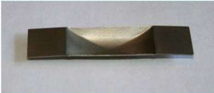
Figure 17 : Creuset du canon à électrons neuf et avant découpe.
