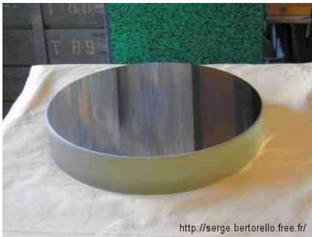
Figure 25 : Le miroir de 400mm vient d'être aluminé.
