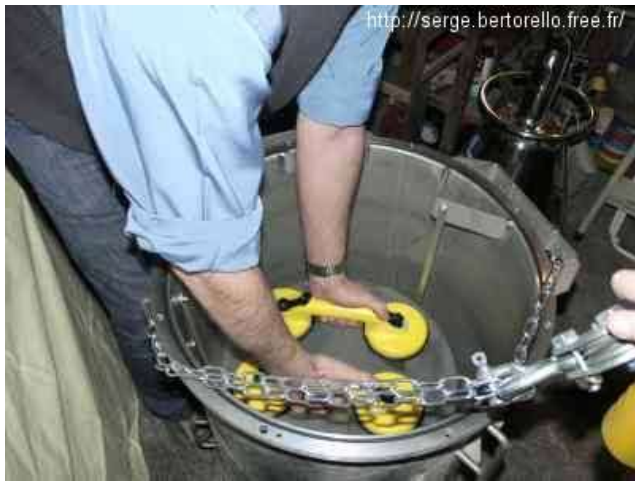
Figure 23 : Mise en place du miroir de 400mm.
