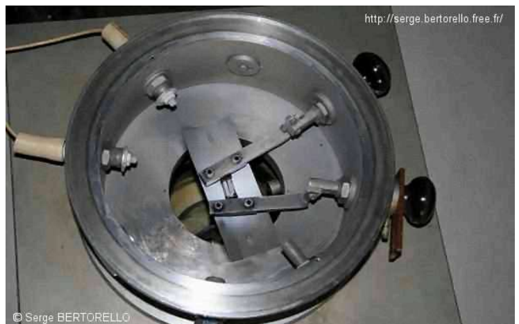
Figure 10 : Le creuset est maintenu au centre de la tourelle par des barres en cuivre.
