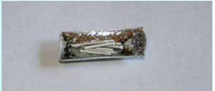
Figure 18 : Creuset du canon à électrons après découpe et après quelques utilisations. Nous avons déposé dans son creux quelques longueurs de fil d'aluminium pour la prochaine évaporation.
